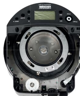
Con l'apertura dell'unità di trasporto consente un facile accesso per la pulizia, la rimozione di oggetti estranei e la regolazione della macchina.
