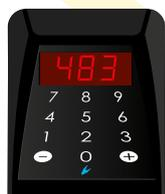
**CONS3** - Console da banco per operatore con display LED a 3 cifre. È provvista di una tastiera numerica e di 2 tasti per avanzamento e decremento (+ e -). È predisposta per il collegamento al display MD3 (in modalità SLAVE) tramite piattina telefonica a 6 poli.
