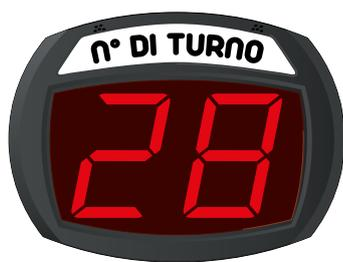
**SD2** - Display elimina code a 2 cifre (da 00 a 99) con digit LED 7 segmenti di colore rosso, altezza cifre 7,5 cm, avanzamento normale o veloce tramite pulsante a filo, lampeggio delle cifre, avvisatore acustico al cambio numero, memorizzazione ultimo numero chiamato in assenza di rete, azzeramento.
