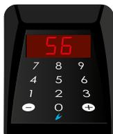
**CONS2** - Console da banco per operatore con display LED a 2 cifre. È provvista di una tastiera numerica e di 2 tasti per avanzamento e decremento (+ e -). È predisposta per il collegamento al display MD2 (in modalità SLAVE) tramite piattina telefonica a 6 poli.
