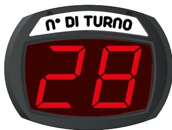
**SD2** - Display elimina code a 2 cifre (da 00 a 99) con digit LED 7 segmenti di colore rosso, altezza cifre 7,5 cm, avanzamento normale o veloce tramite pulsante a filo, lampeggio delle cifre, avvisatore acustico al cambio numero, memorizzazione ultimo numero chiamato in assenza di rete, azzeramento.
