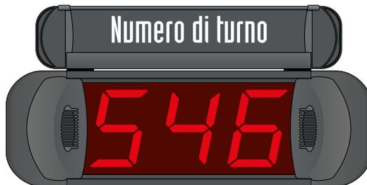
**TD3** - Display elettronico 3 cifre a segmenti luminosi per l'indicazione del numero progressivo di turno. Realizzato in ABS e alluminio è corredato di accessori per l'aggancio a parete. È dotato di avvisatore acustico e lampeggio delle cifre. Tutti i display TD3 possono essere collegati a console da tavolo (CONS3), modulo vocale (VOICE3) ed è possibile collegarne due o più al fine di visualizzare lo stesso numero di turno (MASTER/SLAVE).
